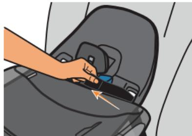
7. Appuyer sur les côtés du tendeur de ceinture SafeLock jusqu'à ce qu'un **DÉCLIC** soit audible. Si le tendeur de la ceinture ne se verrouille pas, essayer de desserrer légèrement la sangle du DUA ou du SAU, puis essayer de nouveau de fermer.
