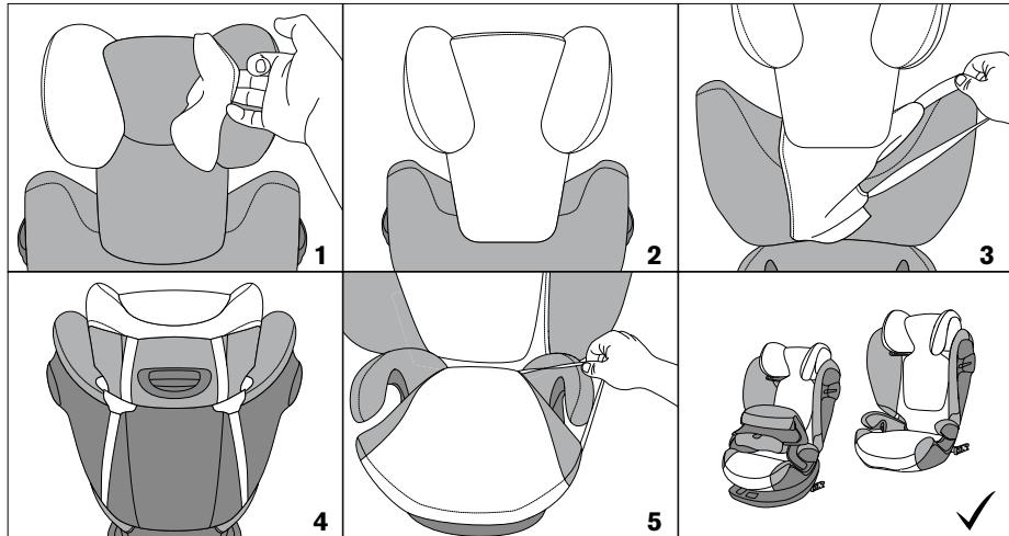
**DE** Bringen sie die Kopfstütze in die höchste Position. Stülpen sie danach die Zugbänder von vorn einzeln über beide Kopfstützlehnen (1). Ziehen sie den Bezug über die Kopfstütze nach unten (2). Ziehen sie dann die Zugbänder über beide Schulterlehnen (3). Die Zugbänder sollten nun wie in der Abb. gezeigt auf der Rückseite des Sitzes anliegen (4). Ziehen sie abschließend die Zugbänder über beide Armstützen (5).
